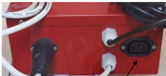
1.-es a ábra – F EURO konnektor a fedél biztonsági zár csatlakoztatására
