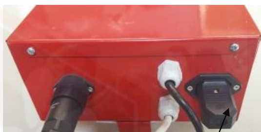
2.-es a ábra - M EURO konnektor a fedél kinyitására szolgáló kinyitására szolgáló biztonsági zár helyett
