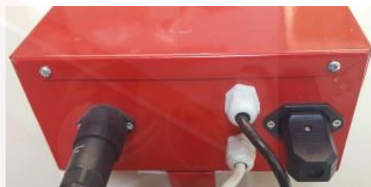
Obr. a2 - EURO konektor F zapojený namiesto bezpečnostného zámku krytu
