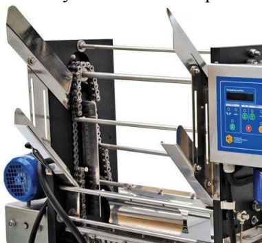
Obr. 4 Regulácia hornej a dolnej časti podávača
