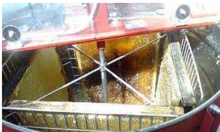
1.-es ábra Keretek elhelyezés tangenciális mézpergetőbe
