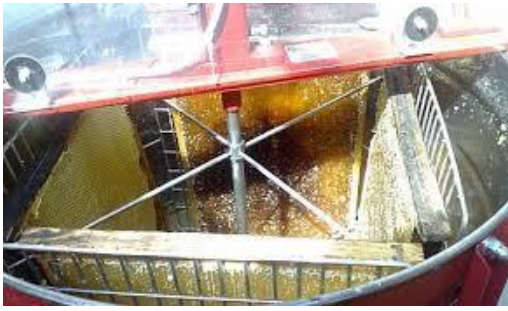
Obr.1. Uloženie rámkov v tangenciálnom medomete
