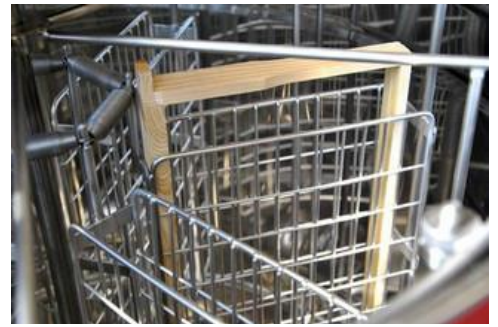
Obr.3. Uloženie rámkov v ručne zvratnom medomete
